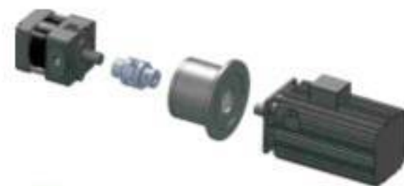
立式伺服电机泵外形分解图
